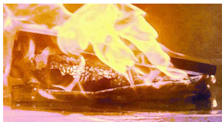
再現実験で発火するモバイルバッテリー＝N I T E提供
