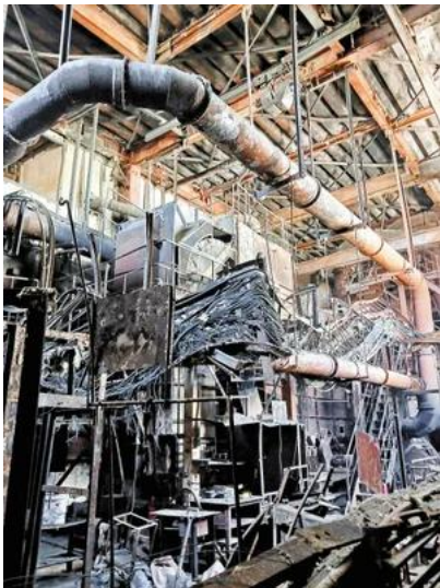
5月にリチウムイオン電池が原因とみられる火災で焼損した大田区の産廃処理施設＝高俊興業提供
